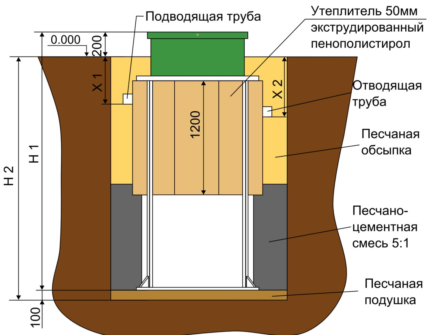
**Рисунок 1. – Размеры станции «ЕВРОБИОН - АРТ»**
