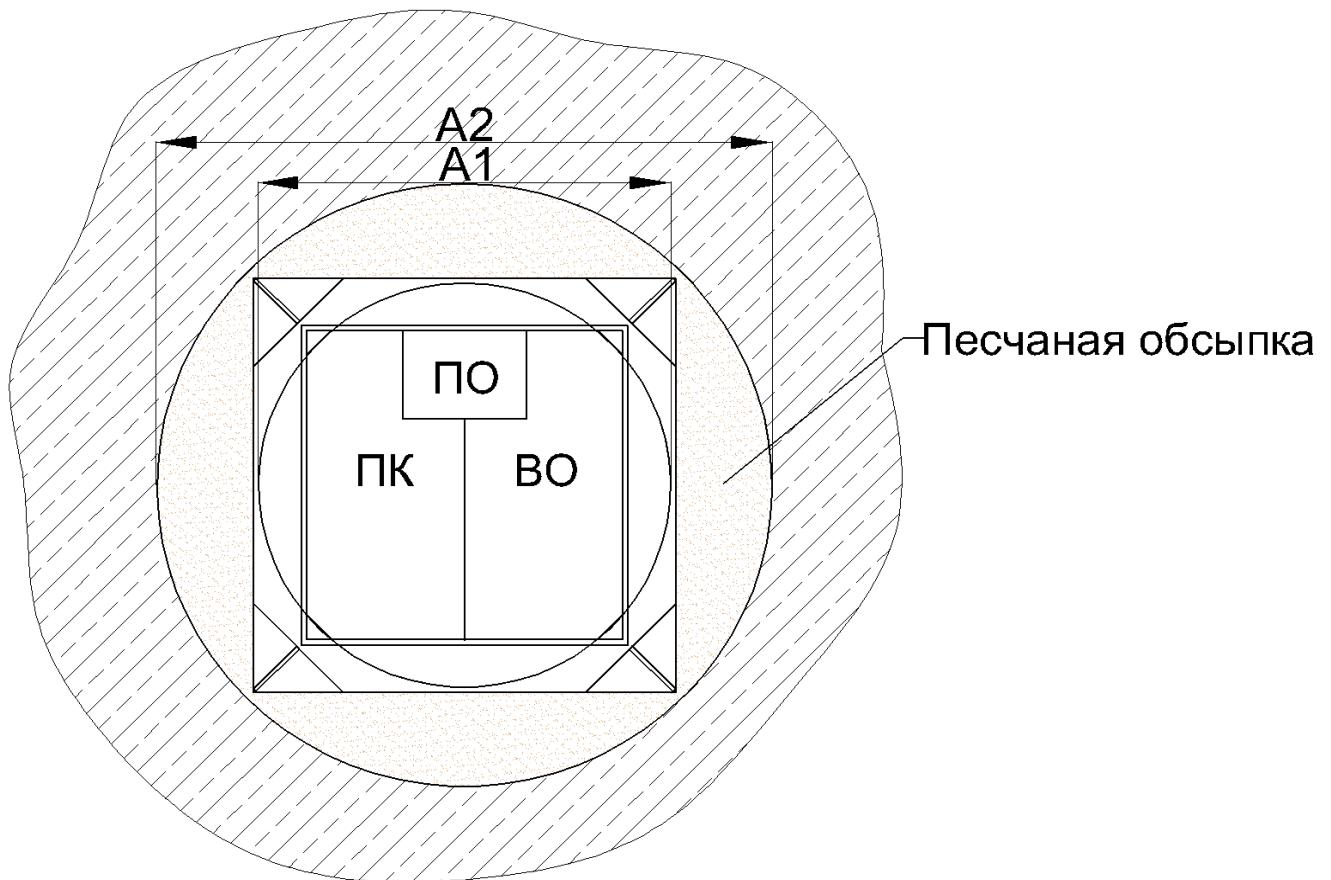
**Рис. 2. Обозначение габаритных размеров станции «ЕВРОБИОН - АРТ» в цилиндрическом корпусе в разрезе (вид с верху).**
