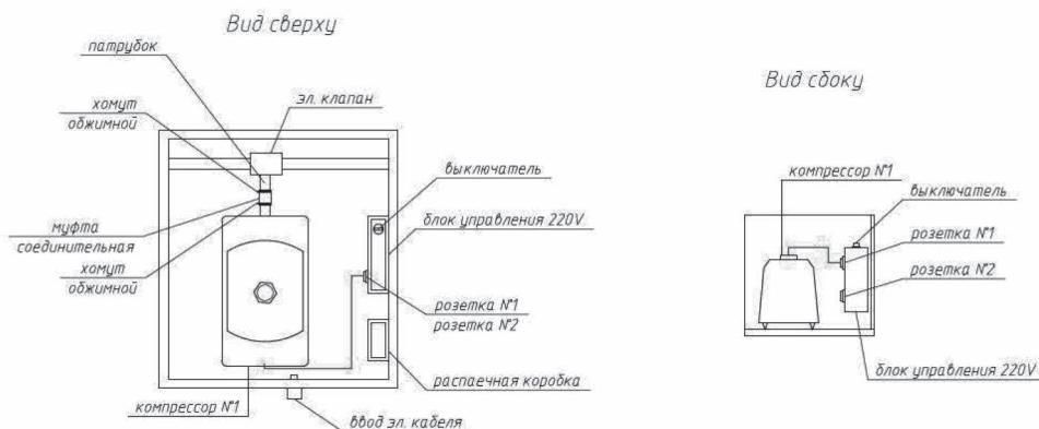
Рис. №2. УОСВ ТОПАС-С 4 -12 ПР с принудительным выбросом очищенной воды
