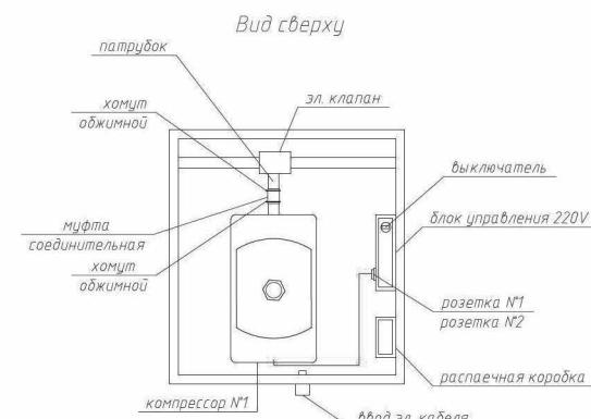
Рис. №1. УОСВ ТОПАС-С 4 -12 с самотечным отводом очищенной воды
