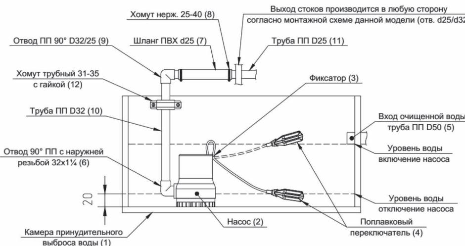
В камеру принудительного выброса очищенной воды (1) устанавливается погружной насос (2). Поплавковый переключатель (4) закрепляется в фиксаторе (3), установленном на насосе (2). Ход поплавкового переключателя (4) должен находиться в свободном положении, для обеспечения беспрепятственного всплытия (включая насос), и опускаться (отключая насос). Поплавковый переключатель (4) на включение насоса (2) устанавливать строго по уровню низа лотка входящей трубы 050 мм (см. схему).
