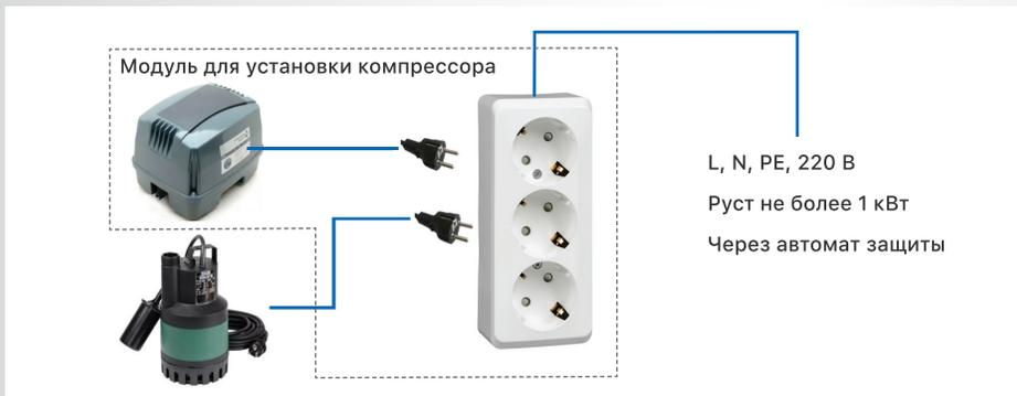
Рис. Принципиальная электрическая схема подключения станции
